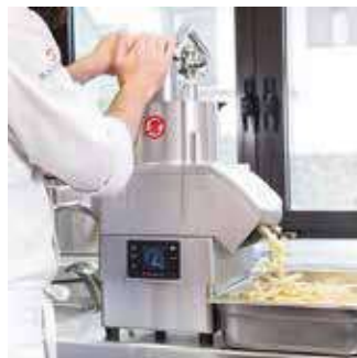
Funzione di taglio: uscita laterale del prodotto.
