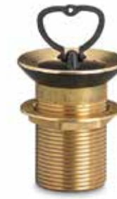
PIL/001 PILETTA GRANDE IN OTTONE Dim. cm H 7 x Ø 6,2 - filetto 1¼"
